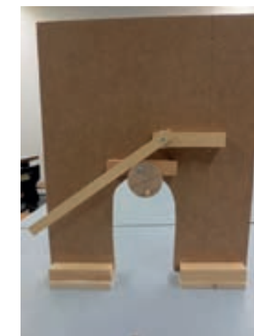
links: Abb. 4 Drehen eines Kreises: Drehpunkt im (zentrisch) und außerhalb des Mittelpunktes (exzentrisch). „Drehpunkt und Mittelpunkt des Kreises sind nicht ident. Beim Drehen der Kreisschablone sind die Abstände zum Drehpunkt unterschiedlich“. (Fast, 2016, S.109). (Bilder: Fast, privat)
