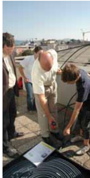
Abb.3 Bei der von den Schüler/inn/en selbstgebauten Therm. Solaranlage zeigt das Oberflächenthermometer über 60 Grad Celsius an.
