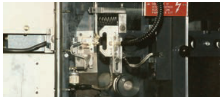
Abb. 5 MINITEK Funkenerosions-Schneidapparat, Foto: Břejcha, 1995 aus Schächter-Nachlass
