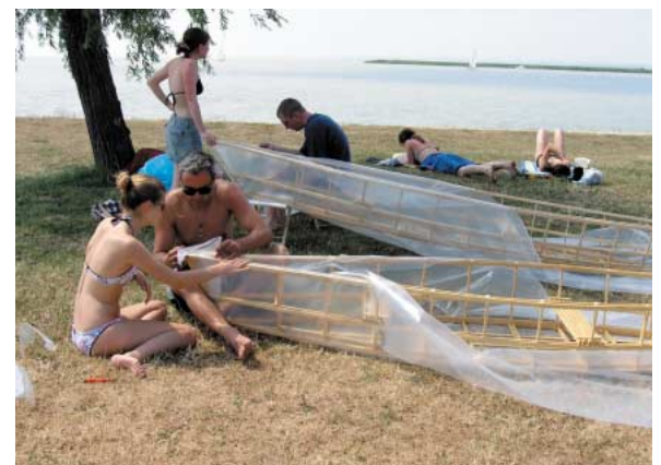
Bespannen der Boote mit Baufolie
