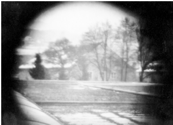
Oben: Der runde Bildausschnitt entsteht durch den langen Rohrteil auf dem sich die Linse befindet
