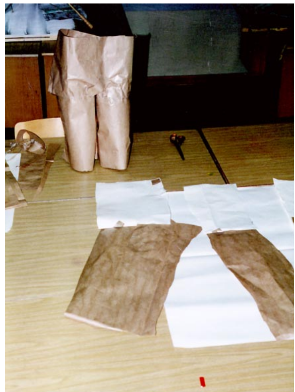
Klärung räumlicher Vorstellung am Beispiel der Hose, durch Herstellung eines Papiermodells
