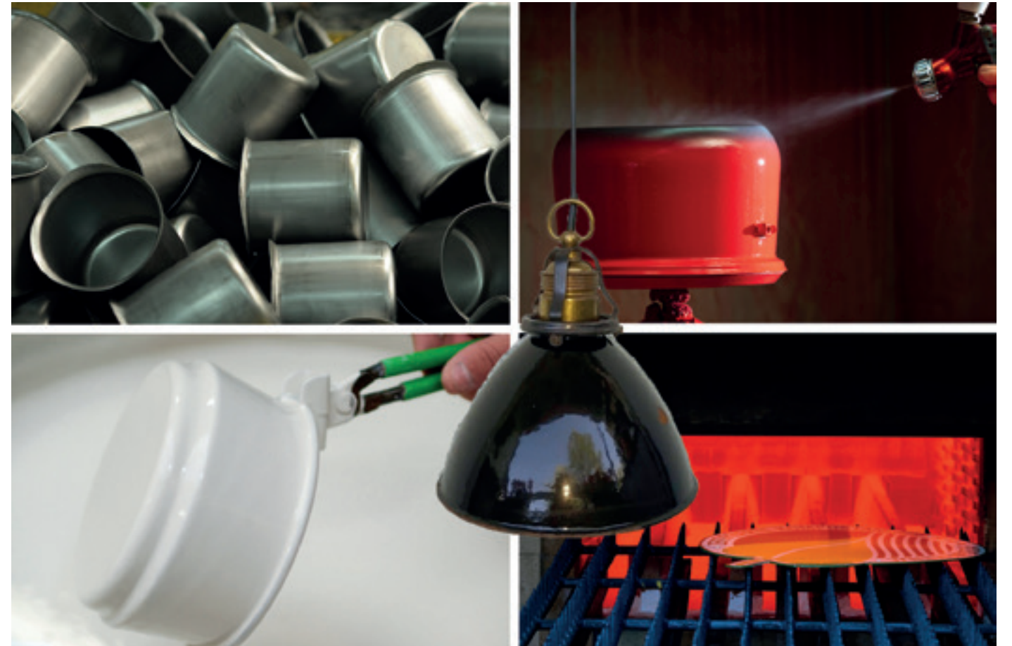
Abb. 10 Step by Step: Eisenrohling herstellen – entfetten – grundieren – emailieren – trocknen – brennen. Abb. 1, 3, 5–10 © Nicole Gucher
