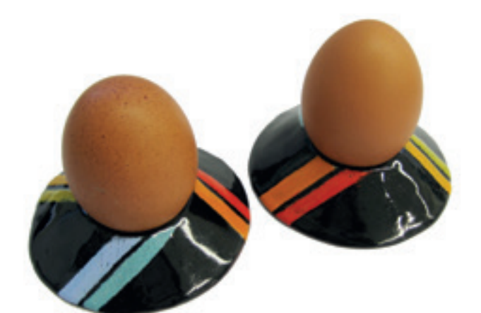
Abb. 6 Schülerarbeit HTL Kramsach: Eierbecher. „Wer Steine und Eier verpackt, soll die Steine nach unten legen.“ – Wilhelm Busch. Kupfer gesägt, gebogen, gelötet und mit Schmuckemail emailliert.
