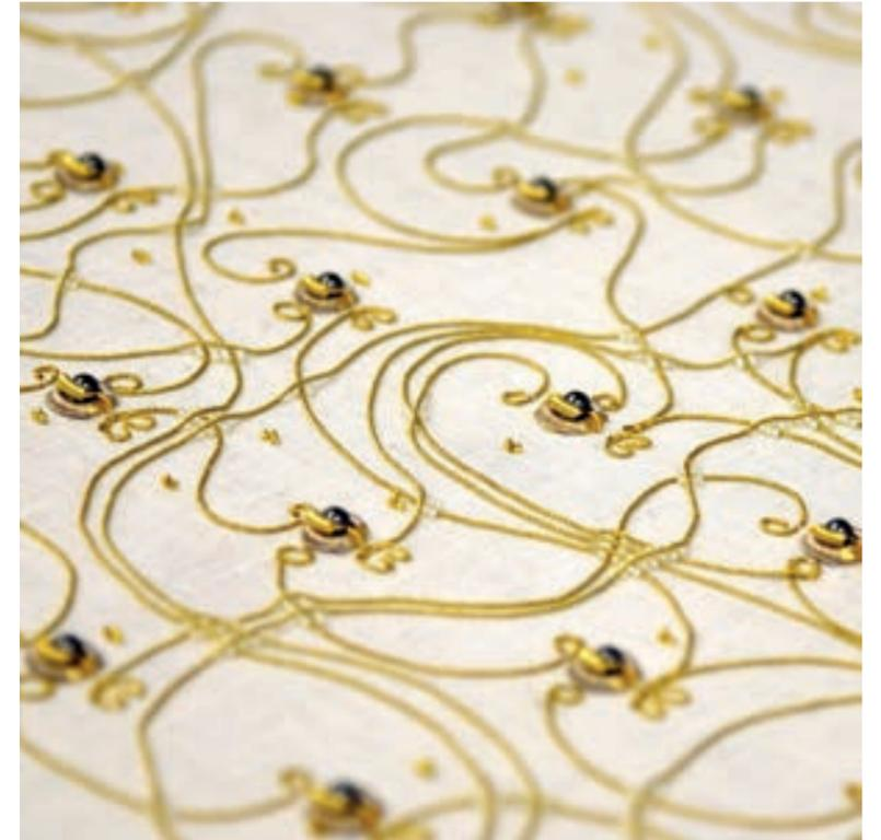
Auch ein Schalter ist ein Sensor – ein Detektor dafür, ob ein Stromkreis geschlossen ist oder nicht. Auch der eTextile Tester beinhaltet einen Schalter: berührt man mit beiden Enden ein leitendes Material, wird der Stromkreis geschlossen, und die LED leuchtet. Berührt man aber ein Material, das weniger leitend ist, kann weniger Strom fließen, und die LED wird weniger hell leuchten – die Leitfähigkeit des Materials, das berührt wird, wird so für uns erfahrbar.
