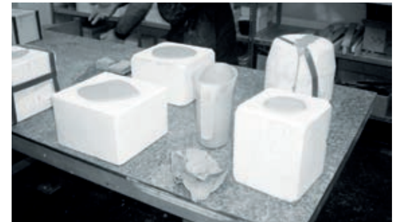
Abb. 4 Ausgegossene Gussformen mit antrocknendem Schlicker (Foto Melanie Berlinger)
