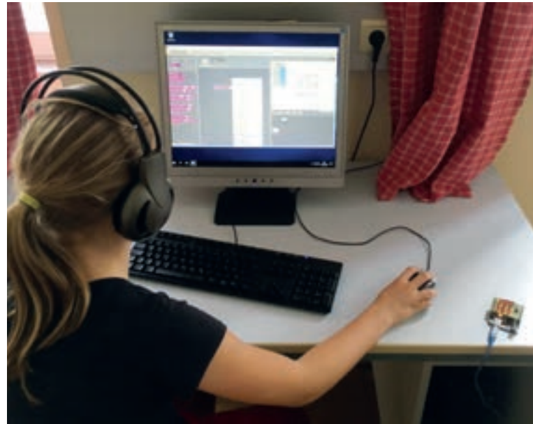
Abb. 2 Mit dem „Scratch for Arduino“ programmiert eine Schülerin ein Geschicklichkeitsspiel für ihre selbst hergestellte Platine.
