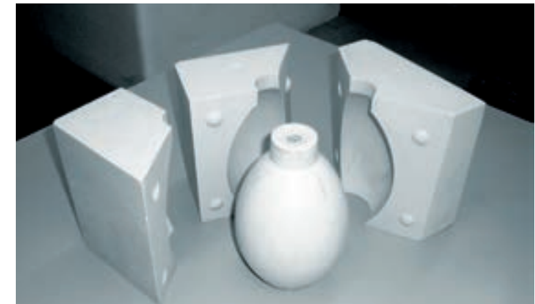
Abb. 3 Herstellen einer mehrteiligen Gussform aus Gips (Foto Melanie Berlinger)
