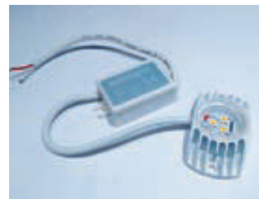
Abb.1 Das Sunlight-LED-Modul der Vorarlberger Firma Kairos kann mit den verschiedensten Stromquellen, von der 9V-Batterie bis zum Handyladegerät, betrieben werden.
