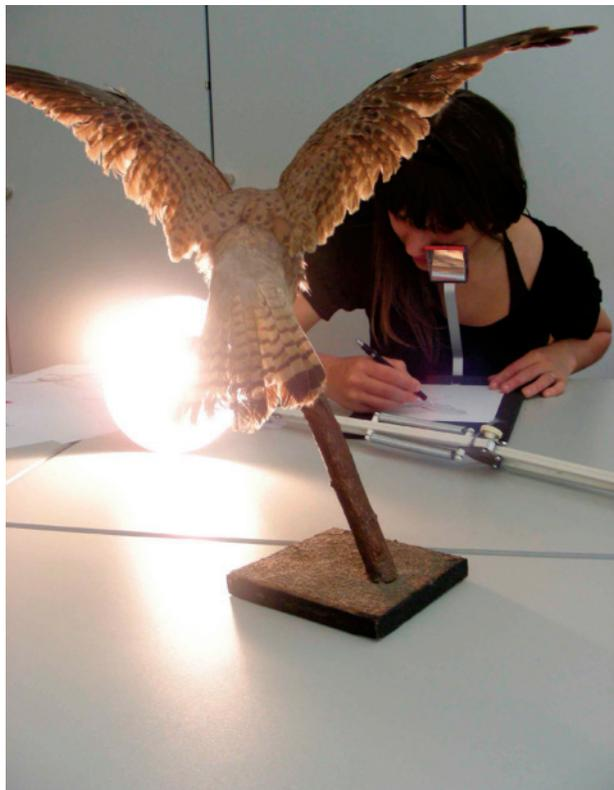
Abb. 3: Das Zeichnen mit der Camera lucida erfordert etwas Übung. Die Konstruktion dieser Zeichenkamera funktioniert folgendermaßen: durch einen Spiegel und eine Glasfläche wird ein betrachtetes Objekt auf die Zeichenfläche projiziert, während gleichzeitig auch Hand und Stift erkennbar sind. Somit kann man das projizierte Abbild eines Gegenstandes „nachzeichnen“.
