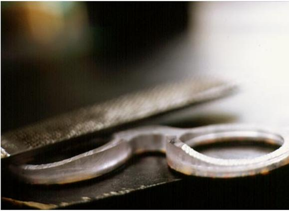
8. Entfernen des überschüssigen Materials an der Rückseite
