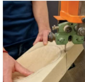
Abb. 9 Je nach Geschmack werden die Schüsseln und Schalen mit der Bandsäge gerade oder schräg ausgesägt
