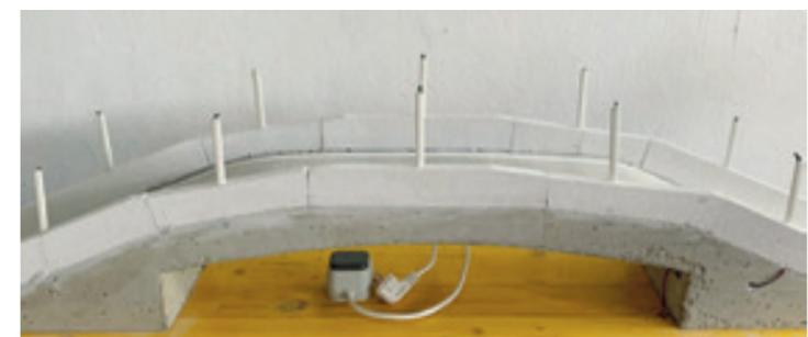
Abb. 4 Durch die freie Materialwahl kamen unterschiedliche Stoffe wie zum Beispiel Porenbetonziegel zum Einsatz
