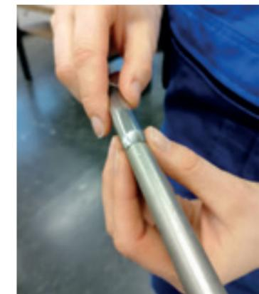
die Fase stark aufgeraut. Diese Rauheit wird im nächsten Schritt beim Feinschleiff überarbeitet, wofür die beölte bzw. bewässerte feinere Seite des Abziehsteines verwendet wird. Je genauer der Vorschleiff durchgeführt wurde, desto besser und schneller wird der Feinschleiff. Die Fase muss auch innen abgezogen werden. Um Innenwölbungen und Innenkanten sauber abzuziehen,
